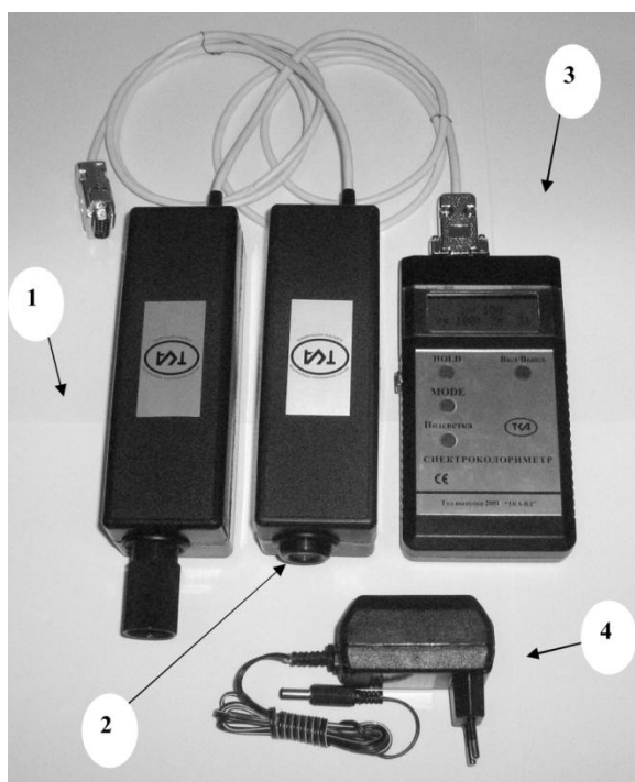
1 – оптоэлектронный блок – 01; 2 – оптоэлектронный блок – 02; 3 – блок обработки сигнала; 4 – сетевой блок питания Рисунок 1 – Общий вид спектроколориметра ТКА-ВД
